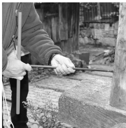
fig. 4 – Verruma manual utilizada para a extracção de amostras
